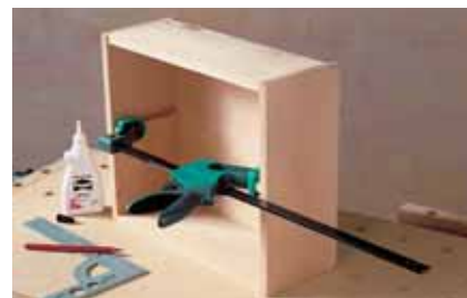
prosta przebudowa do funkcji rozpieraka
