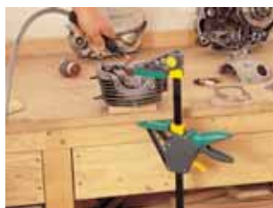
prosta przebudowa do funkcji rozpieraka
