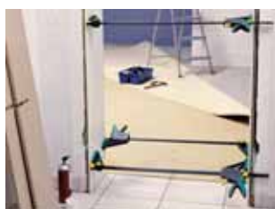
prosta przebudowa do funkcji rozpieraka
