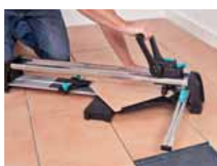
ze specjalnym prowadzeniem do wykonywania cięć po przekątnej
