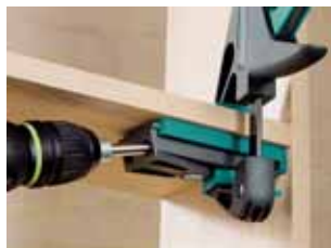
Z użyciem Undercover Jig wiercimy precyzyjne otwory w desce...
