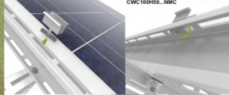
2. Podczas dokręcania śruby SAM8...E kluczem imbusowym następuje blokada nakrętki NRMBPV w profilu CWC100H50...NMC
