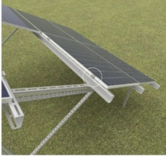
Montaż uchwytych paneli do ceowników CWC100H50...NMC za pomocą nakrętki rombowej NRMBPV
